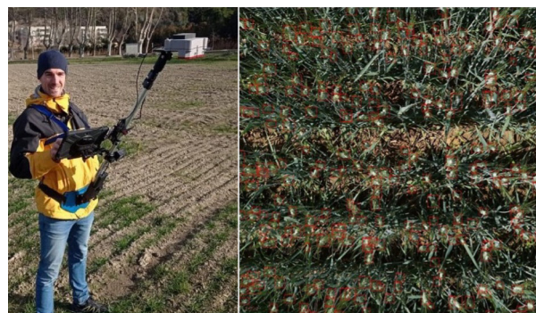
Figure 1 : Présentation d'une perche LITERAL opérée au champ (gauche) et analyse d'une image acquise pour comptage des épis par algorithme (droite).
