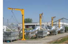
Figure 2: Plateforme C3-GEM, constituée de 4 bulles transparentes posées sur des couverts de blé de 2m 2
